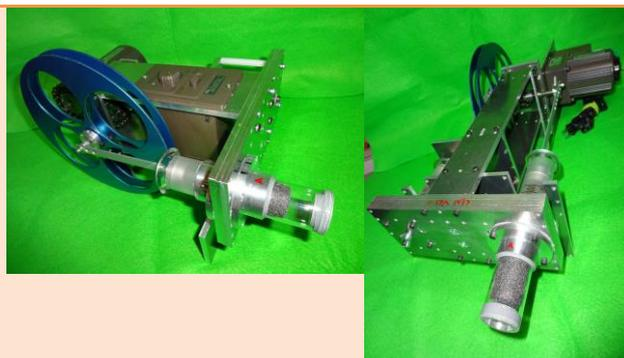
【競技内容】 100V 電源で作動する自作スターリング冷凍機で、規定物(φ20, H20mm アルミ)を 10°C冷却する省電力性を競う。
