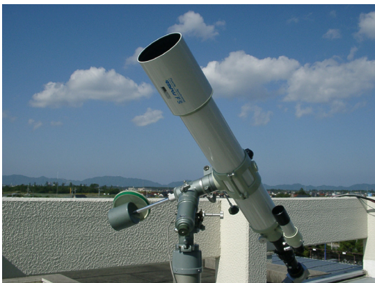
図 3 観測に使用したタカハシ製作所製フローライト屈折望遠鏡 FS-128 とそれを搭載する赤道儀 S-90。
