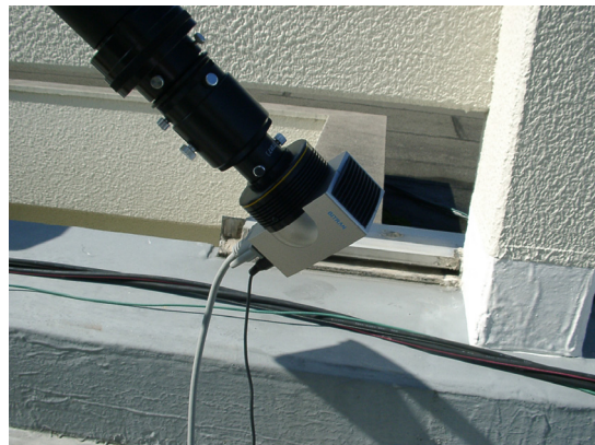
図 5 ビットラン社製冷却 CCD カメラ BJ-41L。望遠鏡の接眼部にこの CCD カメラをとりつけ、パソコンにつなぐことによって観測データを直接とりこむことができる。
