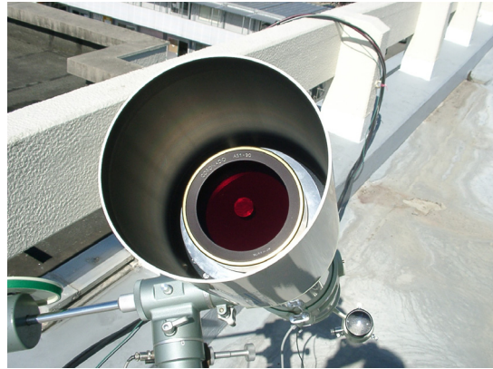
図 4 観測に使用した本校の望遠鏡とコロナド社製 H \alpha フィルタ AS-90。この H \alpha フィルタは望遠鏡の対物レンズの前面にとりつけて使用するため、フィルタのムラがでにくい構造になっている。なお、フィルタの透過波長帯の半値幅は 0.7Å である。
