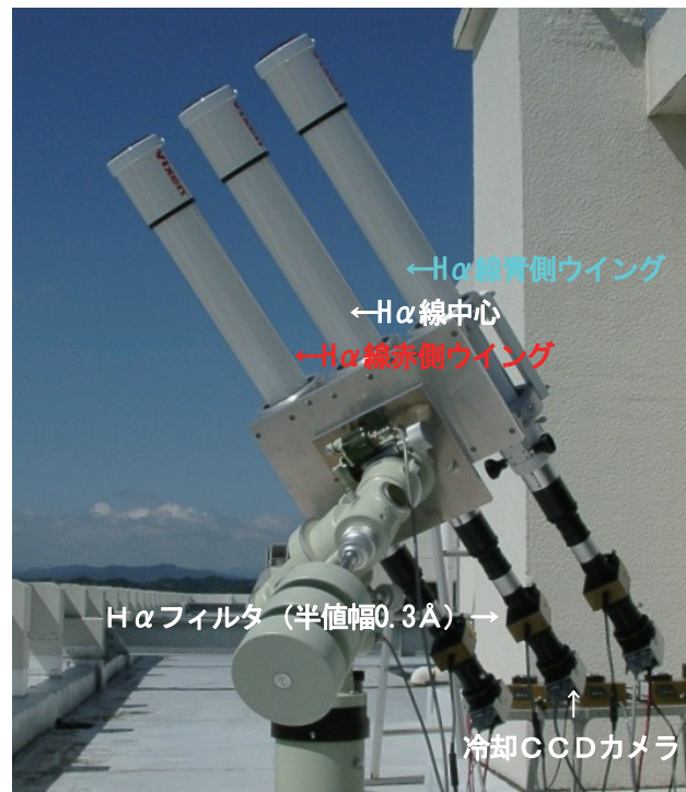
図1. 本校に設置した太陽彩層速度場観測望遠鏡。H \alpha フィルタと冷却CCDカメラを搭載した屈折望遠鏡3本を単一赤道儀に同架している。
