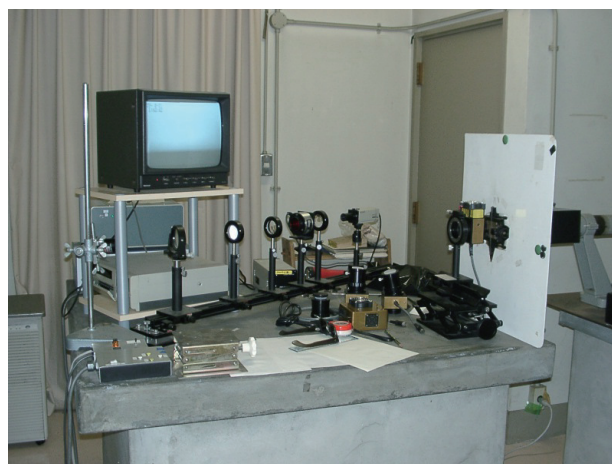
図4. シーロスタットの観測室。シーロスタット付属の反射望遠鏡の光は左側より入射し、右側の白板上に結像して直径約20cmの太陽像を結ぶ。白板の中央部にはスリットがあり、太陽光を右側の水平分光器に導く。H \alpha フィルタの検定はスリットの前にフィルタを固定し、フィルタを透過した光だけを分光器に入射させ、それを調べることにより行った。
