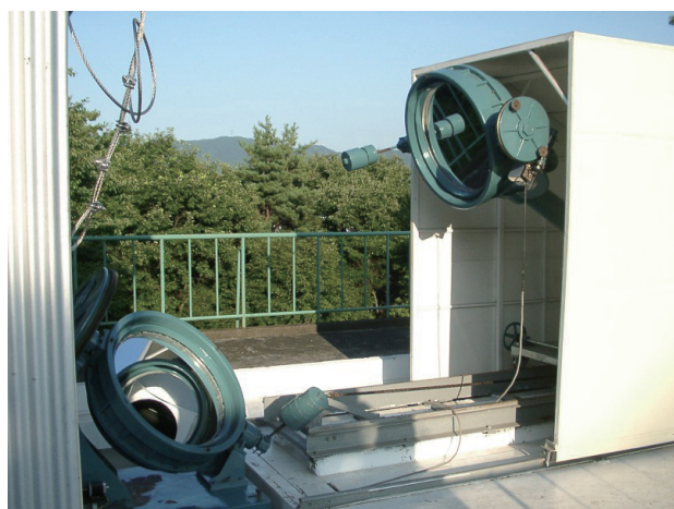
図3. 京都大学大学院理学研究科附属花山天文台のシーロスタット。2枚の鏡で太陽光を常に一定の方向に導く仕掛けになっている。導かれた光は水平に固定された口径50cm、焦点距離20mの反射望遠鏡に入射し、観測室内のスリット上に結像する。なお、この望遠鏡は口径比F40であるため、H \alpha フィルタの使用条件「口径比F30以上」を満たしている。
