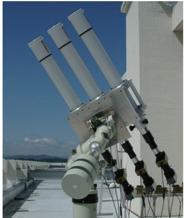
図 3. 米子高専の太陽彩層速度場観測望遠鏡。3 本の望遠鏡で H \alpha 線の線中心、青側ウイング、赤側ウイングの光の強度を測定し、H \alpha 線の視線速度、線強度、線幅を推定する。なお、今回の観測では中央の一本だけを使用した。
