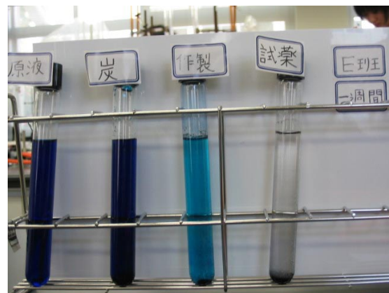
図7 吸着性能試験 (平成16年度)
