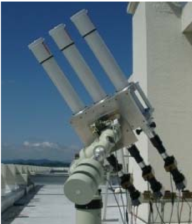
図3. 本校屋上にある太陽彩層速度場観測望遠鏡
