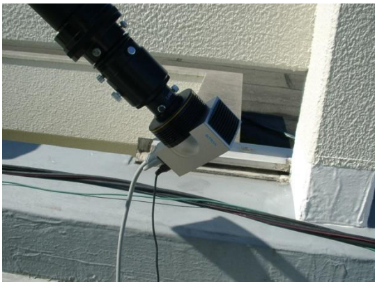
図 2 ビットラン社製冷却 CCD カメラ BJ40-L。
