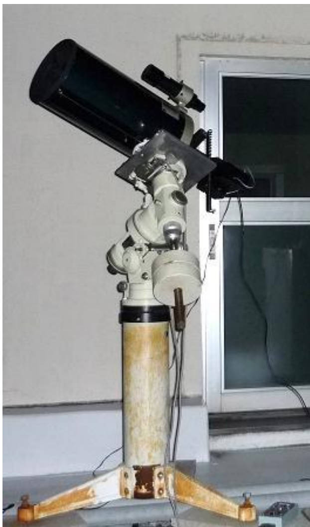
図 2 望遠鏡 VC200L を JP 型赤道儀に搭載し、分光器 DSS-7 と CCD カメラ ST402 を装着して観測を行った。
