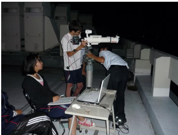
図 3 望遠鏡 ED81S を S-90 型赤道儀に搭載し、分光器 DSS-7 と CCD カメラ ST402 を装着して観測を行った。
