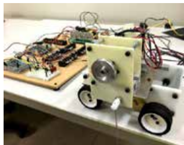
図 台車クレーン実験装置
