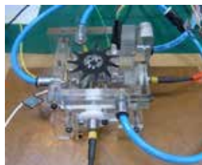
軸受内径 3mm 直交 2 軸油膜厚さ測定 実験装置写真
