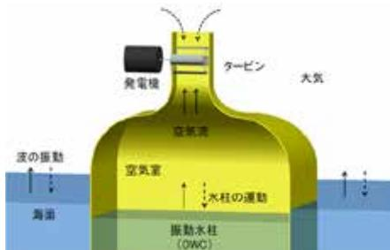
図3 振動水柱型波力発電プラント
