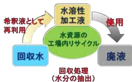
環境問題に対する産業界の取り組みが活発になった 2000 年代初頭頃から、金属加工分野では水溶性加工液による環境負荷対策がクローズアップされました。研究的アプローチの多くは加工液の使用量をできるだけ減らすことによって、加工液そのもののコストや加工中の加工液供給系も含めたエネルギーを削減しようとするものでした。特にわずかな加工液を霧状にして噴射する加工法が着目され、企業等で導入されている事例も多く見られるようになりました。しかし、そのような新しい方法では全ての加工分野をカバーすることはできません。また、新しい方法を導入するのには事前の調査研究やコストが必要であるため、特に中小企業等では普及が進んでいないのが現状であるといえます。
