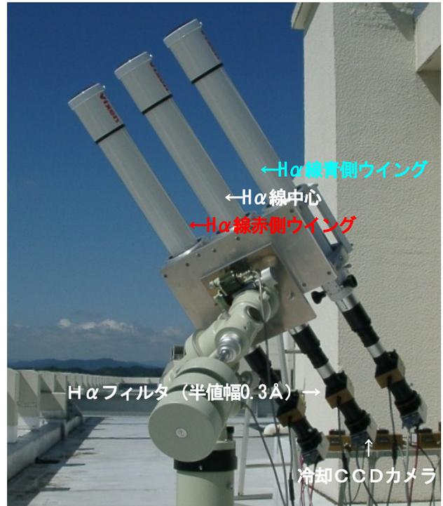
図3. 本校に設置した太陽彩層速度場観測望遠鏡。H $\alpha$ フィルタと冷却CCDカメラを搭載した屈折望遠鏡3本を単一赤道儀に同架している。
