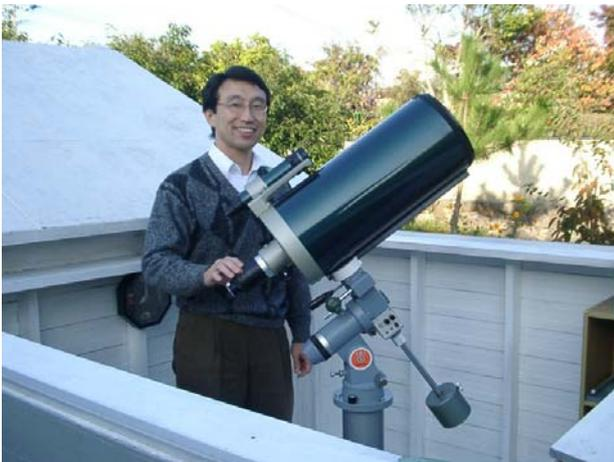
図 4 ビクセン製 20cm 反射望遠鏡 VC200L、CCD で撮像観測に使用。
