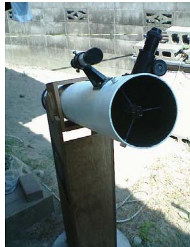
図 7 オルビウス製 10 cm 反射望遠鏡、眼視観測に使用。
