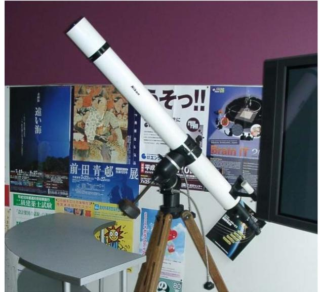
図 5 ニコン製 8cm 屈折望遠鏡、眼視観測に使用。
