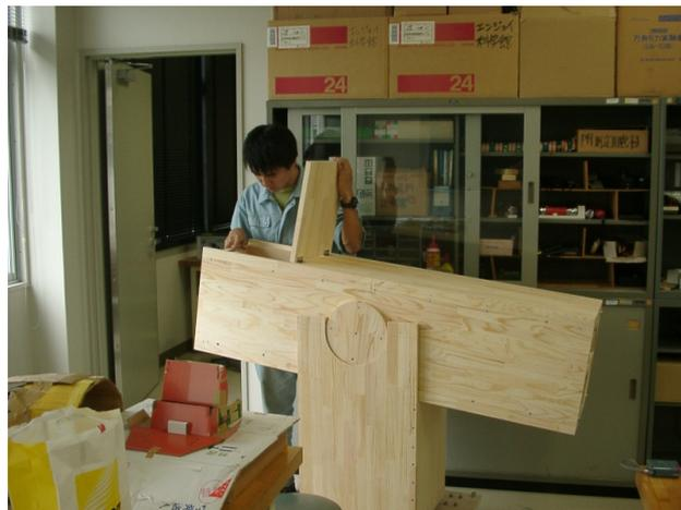
図3. 外形が完成したところ。耳軸が軸受けとしっかり接触しているのが分かる。
