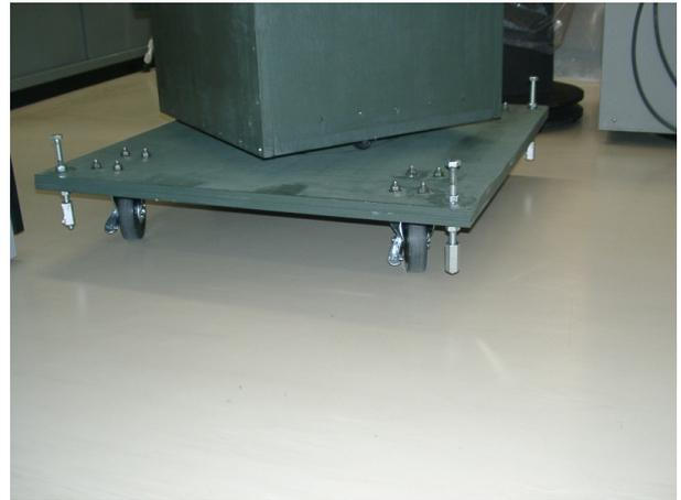
図 8. 架台の車輪と固定用のボルト。移動しやすいように大直径の車輪を取り付けた。さらに、観測の際に不安定になるのを防ぐために固定用のボルトが装備してある。観測時にはこれを下ろして望遠鏡を固定する。
