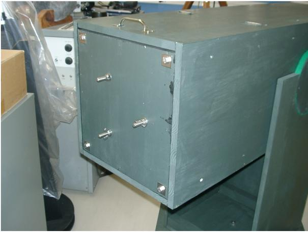
図 11. 鏡筒の後面。三ヶ所にあるネジは主鏡セルを固定しているものである。これらは底板のパネを介した押し引きネジになっており、これらで主鏡の光軸を調整する。
