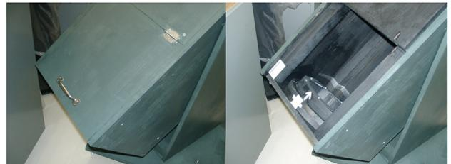
図 9. 主鏡上蓋。左側は閉じた状態で扱いやすいようにとってを取り付けた。右は開いた状態、普段は主鏡にカバーが被せてあり、埃の付着を防げるようになっている。
