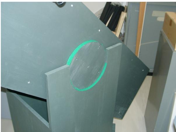
図 7. 耳軸の拡大図。軸と軸受けの両方にフェルト（緑色の部分）を貼り付けることで、よりスムーズな操作性を得ることができた。
