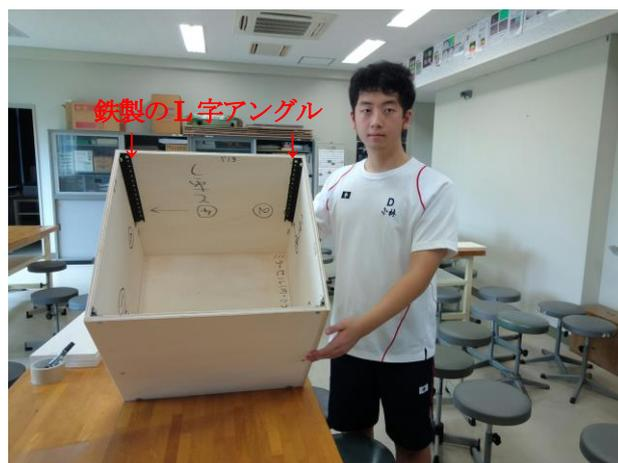
図 4 主鏡収納部の角に L 字アングルをとりつけ、こことジョイントを接続し、接続部分の強度を増した。
