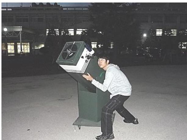
図 2 以前製作した 10 吋ドブソニアン望遠鏡。厚さ 18mm のパイン集成材を組み合わせた非常に頑丈な鏡筒となっている。
