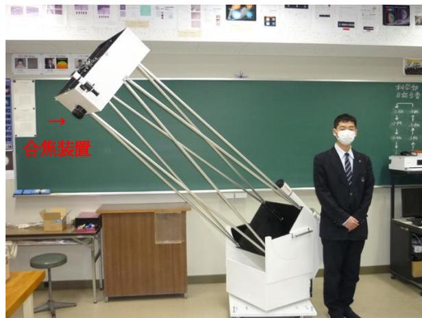
図 8 合焦装置は接眼部の下面に取り付け、接眼部をねじるモーメントが発生しないようにすると同時に、身長が低い小学生でも接眼鏡を覗きやすくした。
