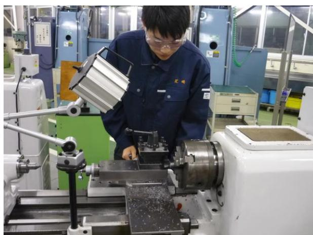
図 5 ジョイントはものづくりセンターの旋盤、フライス盤、グラインダーを用いて製作した。
