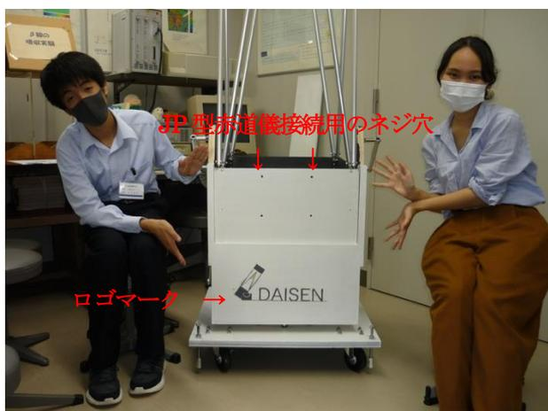
図 9 架台にロゴが入ったドブソニアン望遠鏡。鏡筒下面の 4 個の穴は JP 型赤道儀接続用のネジ穴。
