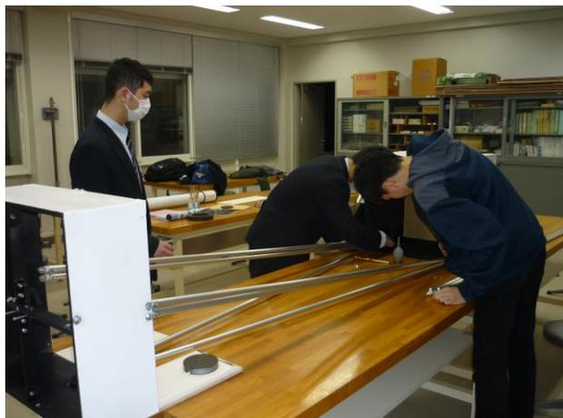
図 6 主鏡収納部と接眼部を 8 本のアルミパイプで接続。
