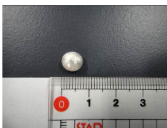
Fig.2 一人分の廃液量から回収された銀塊
