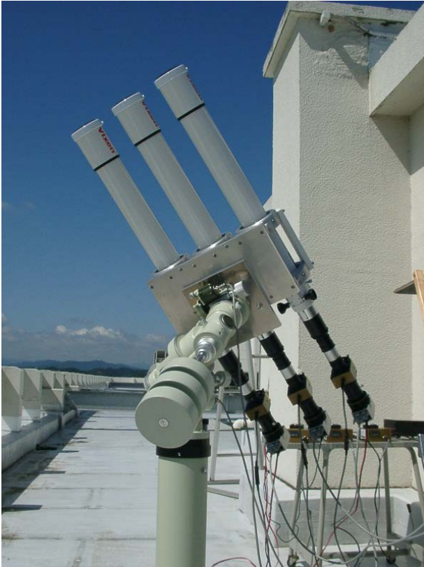
図 2 太陽彩層速度場観測望遠鏡。観測で使用したのは中央の1本のみである。
