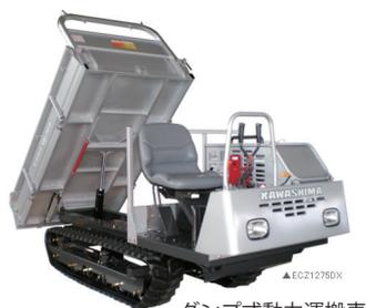
ダンプ式動力運搬車
