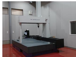
高度検査装置：3 次元測定器
