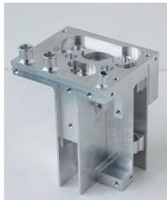
5 軸マシンによる航空部品加工事例
