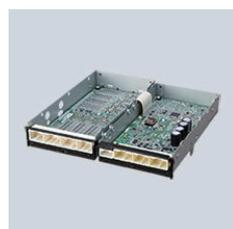
車載電池用制御基板
