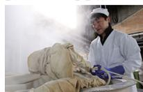
白米の「蒸し」の研究には、特に力を注ぎ、大小2機を使い分け、間接蒸気で蒸し、気候・気圧に左右されない、理想の乾燥蒸気が可能になり、常に外硬内軟の蒸し米が出来上がります。
