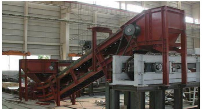
熱間クロップコンベア（全長 350m）（設計・製作品）
