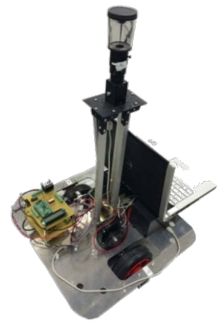
写真2 全方位カメラを搭載した移動ロボット
