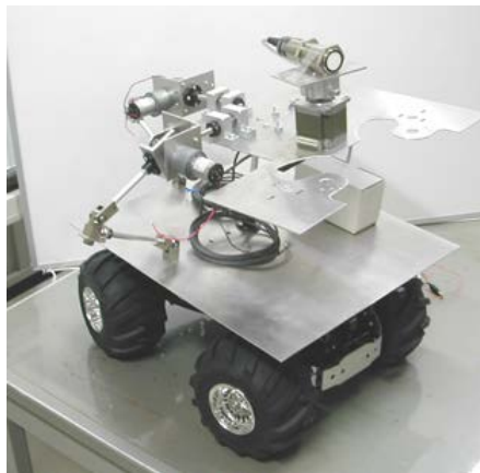
写真1 水平維持機構を搭載した移動ロボット
