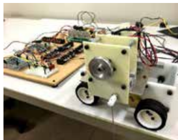
図 台車クレーン実験装置
