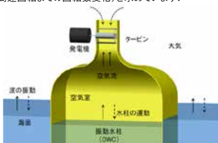
図 3 振動水柱型波力発電プラント
