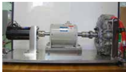
図1 埋込永久磁石同期モータ実験装置
