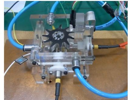
軸受内径 3mm 直交 2 軸油膜厚さ測定
