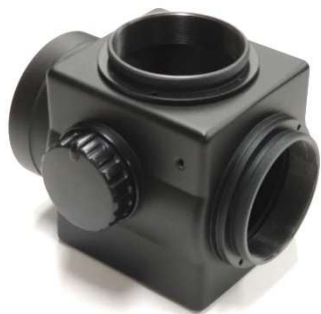
図4 市販の光路切換器を改造して回折格子収納部とし、0次と1次スペクトルを切換可能とした
