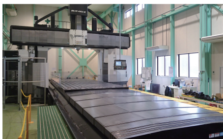
【第5工場】 5面加工マシニングセンタ（MCR-A5C II 30×80）
