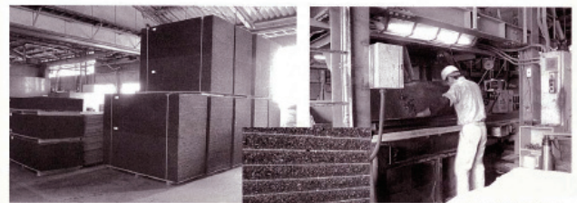
山積みされた EM パネル EM パネルの断面は圧縮され細かな粒子のようになっている。
