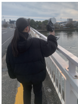
LiDAR SLAM 技術を用いた測量の一例 ▲
