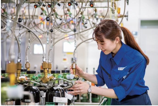
医療ガス充填作業の様子
