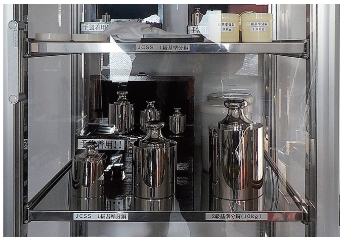
計量器の校正・検査に使用する1級基準器（分銅）
