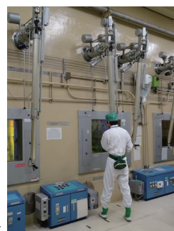
放射性物質を遮蔽壁を介して遠隔操作を行う「マニプレータ作業」▶
