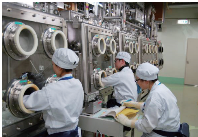
放射性物質を隔離して、目視しながら取り扱う「グローブボックス作業」
