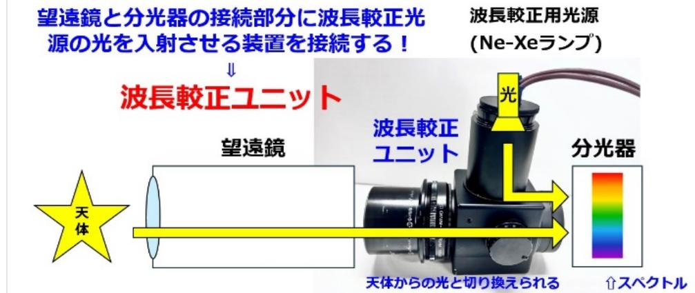
図5 本波長校正ユニットは望遠鏡と分光器の間にはさんで使用する
