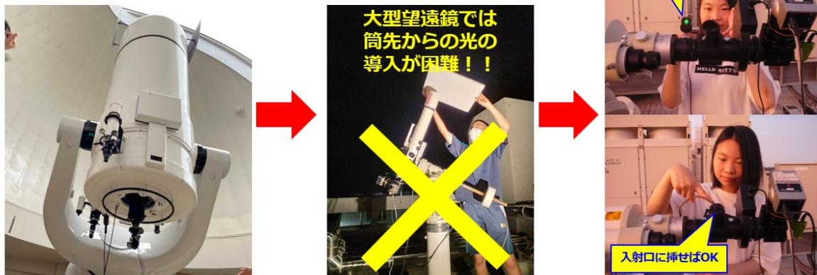
図11 本波長較正ユニットを用いた波長較正
