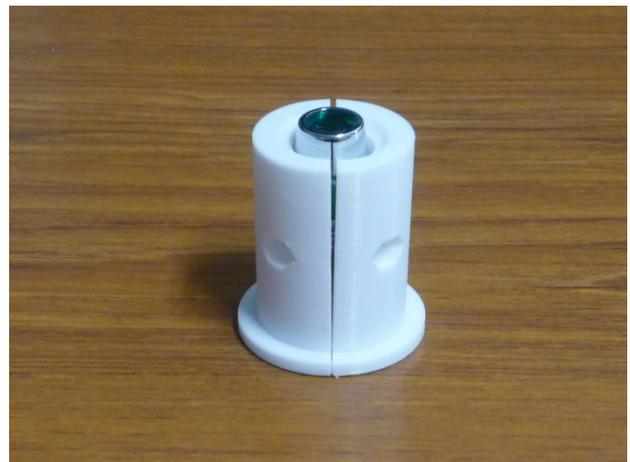
図10 左：Ne-Xe ランプの光源保持具 右：ランプを光源保持具ではさんで波長較正ユニットの入射口に挿入する
