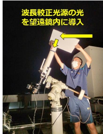
小型望遠鏡での波長較正・フラット撮像の様子。白板で較正光源の光を反射させ、望遠鏡内に導入する。
