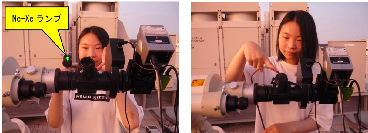
図 2.2.1 左 : Ne-Xe ランプ 右 : TORIHICO に Ne-Xe ランプを取りつけた写真
