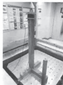
図1. 接合部要素を取り出した試験体
