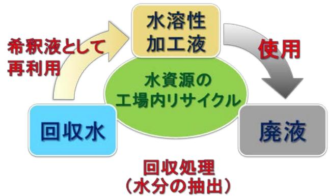
環境問題に対する産業界の取り組みが活発になった 2000 年代初頭頃から、金属加工分野では水溶性加工液による環境負荷対策がクローズアップされました。研究的アプローチの多くは加工液の使用量をできるだけ減らすことによって、加工液そのもののコストや加工中の加工液供給系も含めたエネルギーを削減しようとするものでした。特にわずかな加工液を霧状にして噴射する加工法が着目され、企業等で導入されている事例も多く見られるようになりました。しかし、そのような新しい方法では全ての加工分野をカバーすることはできません。また、新しい方法を導入するには事前の調査研究やコストが必要であるため、特に中小企業等では普及が進んでいないのが現状であるといえます。
