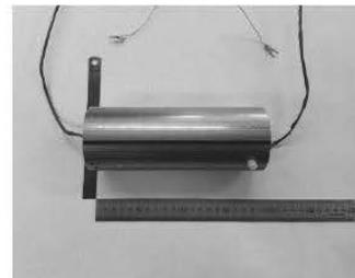
図2. 作製した制震デバイス
