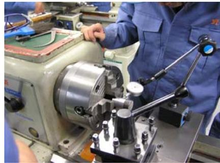
旋盤四ツ爪チャック芯出し作業
