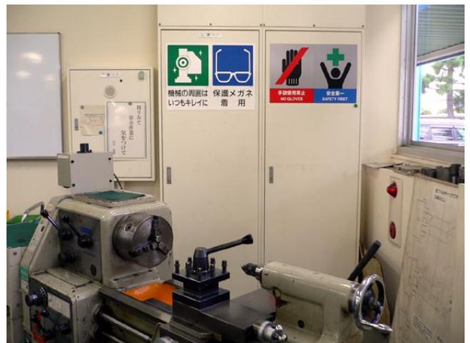
図3 安全標識などが整備されたものづくりセンター内動において混乱・誤操作が生じないように配慮し同型の機種を選定した。また、最も設置台数が多く実習授業・課外活動でも稼働の多い汎用旋盤については、チャックハンドルの抜き忘れを防止する安全装置を導入したり、主軸逆転スイッチを無効にするなど、機種更新にあわせて学生のうっかりミスによる事故を未然に
