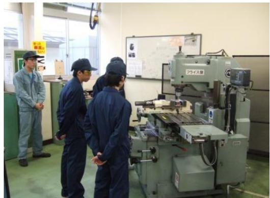
写真1 「機械加工入門」フライス盤加工の様子
