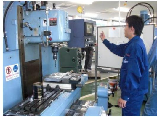
写真3 NCフライス盤による加工の様子
