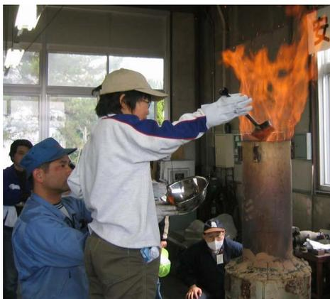
図-2 砂鉄投入時の様子
