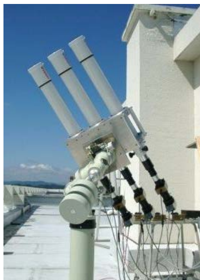
図 1 太陽彩層速度場観測望遠鏡
