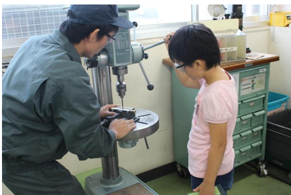
ボール盤による穴あけ作業
