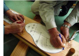
【写真11】脚原寸図写し
