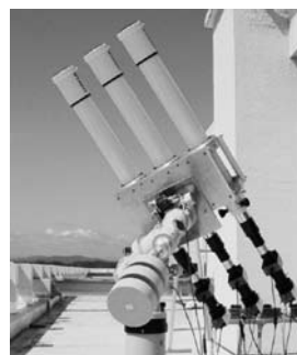
図1 米子高専に設置された太陽彩層速度場観測望遠鏡「チビ」
