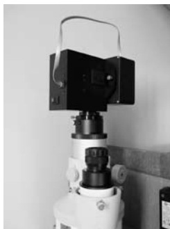
図4 望遠鏡に取り付けた小型分光器DSS-7
