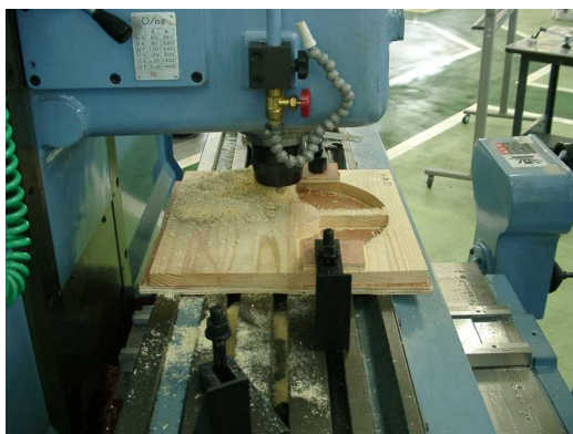
写真-3 NC フライス盤による加工
